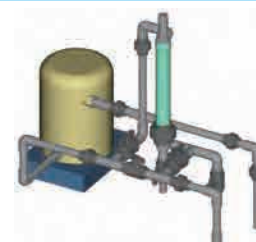
通水試験を実施後、ユニオン継手を緩め本機を設置し取付完了
